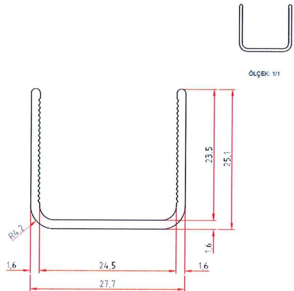
Abb. 2-5 Kantenschutz 27,7x25,1x1,6
